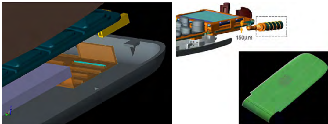
图 2-11 手机封装对天线辐射性能的影响
